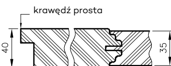
Przekrój poziomy drzwi Nestor
